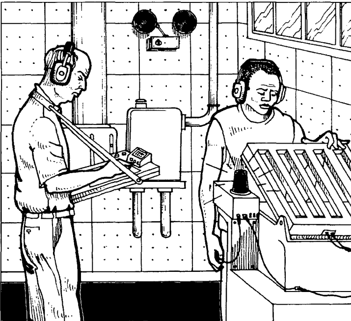
Figura 90b. Asegúrese de que los protectores auditivos son efectivos pero no impiden la comunicación necesaria. Las señales luminosas de emergencia y las alarmas son medios importantes de comunicación cuando se llevan protectores auditivos
