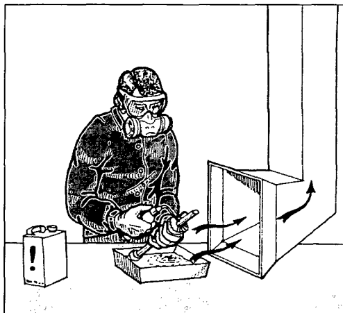
Figura 101a. Los humos nocivos pueden ser captados por sistemas de extracción localizada para evitar la exposición del trabajador al riesgo por contaminantes químicos
