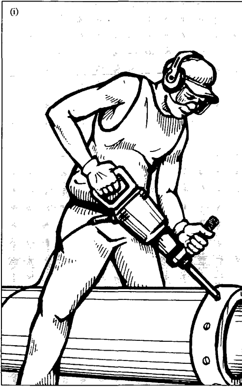
Figura 28. (i) y (ii) Unos agarres firmes de las herramientas mecánicas reducen la fuerza requerida para su manejo
