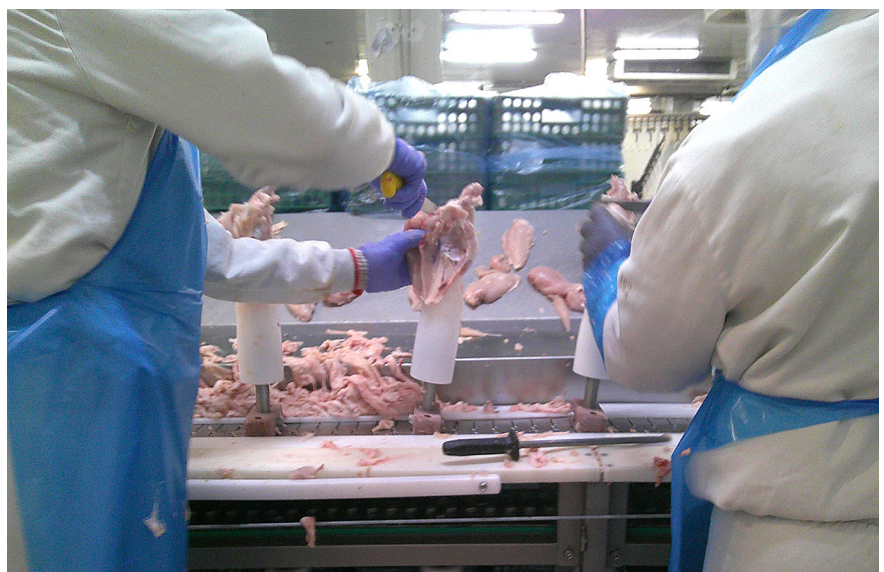
Figura 2: Trabajo de extracción de las pechugas de pollo: la trabajadora corta la pechuga con la mano derecha mientras tira de ella con la mano izquierda. Se ve la chapa donde se depositan las pechugas una vez cortadas
