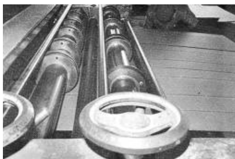
Fig. 2: Cizalla circular (para cortar y hender) con las cuchillas y los anillos accesibles
