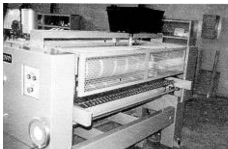
Fig. 6: Carcasa protectora del acceso posterior - superior a cilindros en movimiento
