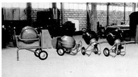
**Fig. 1: Diferentes tipos de hormigoneras móviles**
