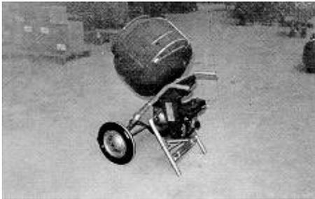
**Fig. 7: Hormigonera de gasolina**
