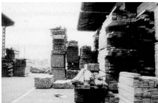
Fig. 2: Apilado incorrecto sobre un paquete semivaciado
