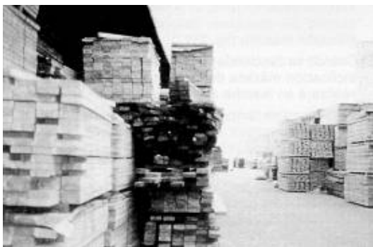
Fig. 2: Apilado incorrecto sobre un paquete semivaciado
