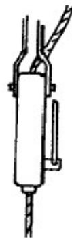
Figura 4. Vista lateral del aparato de seguridad. Operación de salida del cable por la parte inferior
