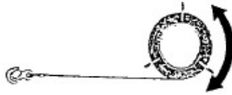
Figura 14. Almacenamiento de los cables
