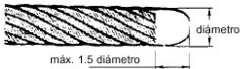
Figura 11. Extremo del cable libre
