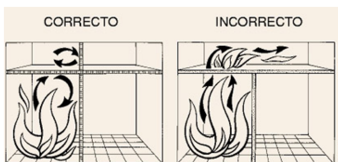
Figura 2. Tabiques y dobles techos
