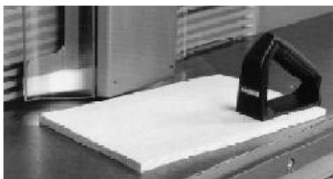
Figura 12 Esquema de tupí para trabajos con guía
