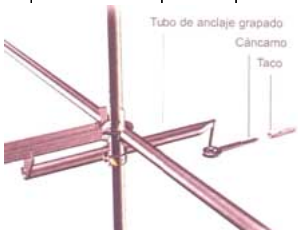
Esquema de anclaje por tacos expansibles
