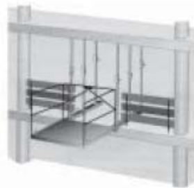
Figura 21 Plataforma de recepción de materiales protegida
