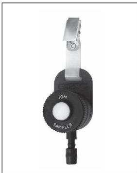
Figura 11. Muestreador IOM multifracción
