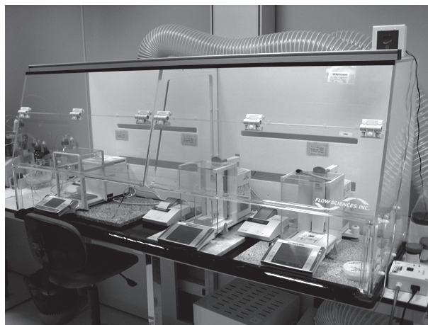
Figura 1. Cabina de pesada para principios activos
