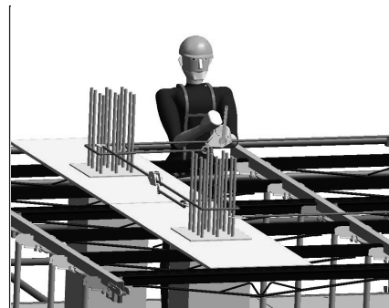
Figura 14. Detalle de tensado con la carraca de vida a ferralla
