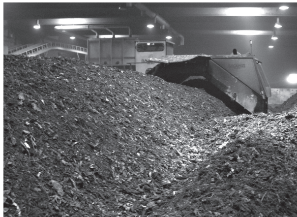
Figura 2. Volteo de las pilas mediante volteadora
