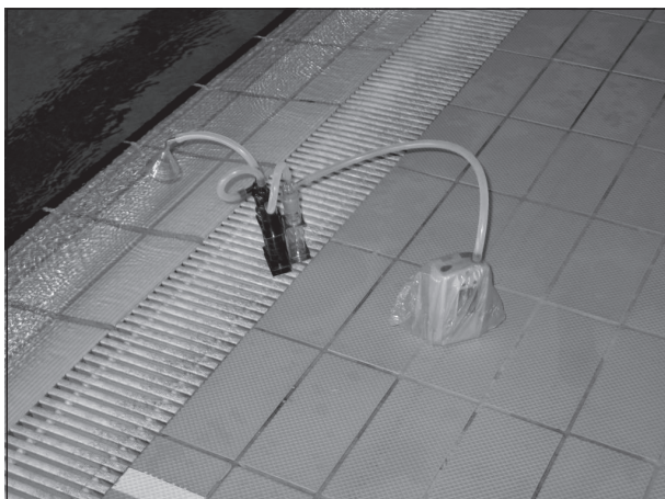
Figura 1. Toma de muestras de oxidantes en aire
