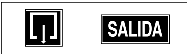
Figura 3. Señalización de salidas habituales según norma UNE 23034
