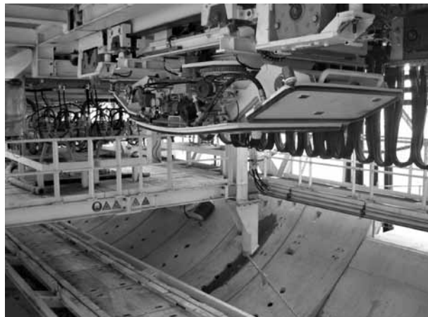
Figura 5. Erector de dovelas de una tuneladora de presión de tierras
