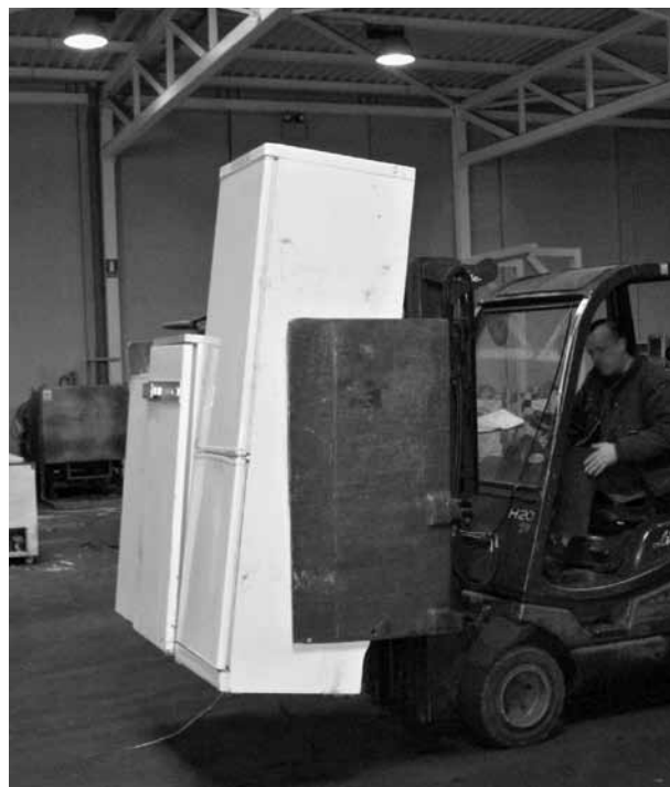
Figura 2. Carretilla para la manipulación de los frigoríficos
