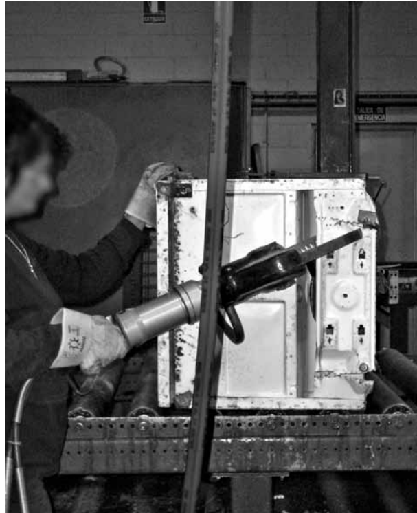
Figura 2. Operación de extracción del compresor de los frigoríficos
