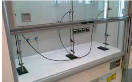
Figura 12a. Posición de los inyectores dentro de la vitrina
