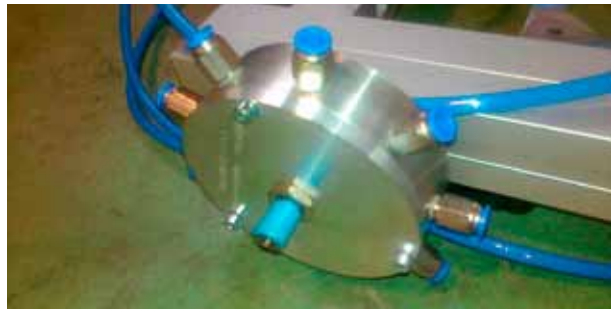
Figura 5. Detalle del colector de toma de muestras
