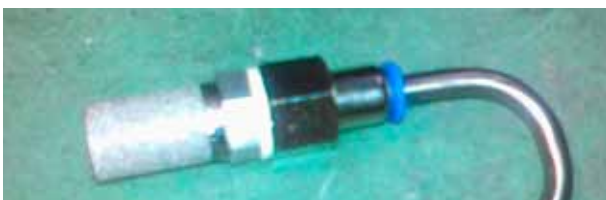
Figura 3. Detalle del inyector del gas de ensayo
