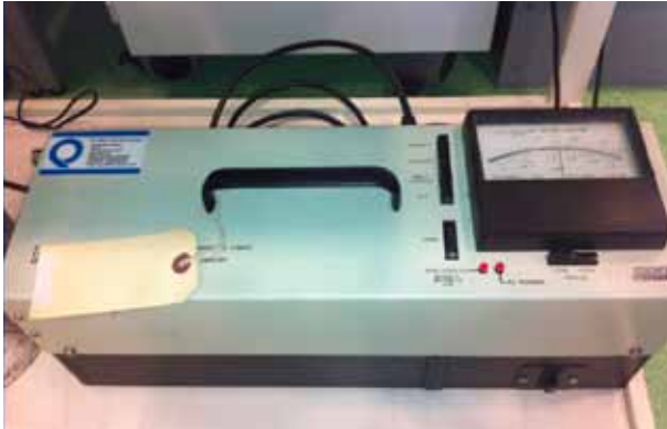
Figura 7. Detalle del analizador infrarrojo
