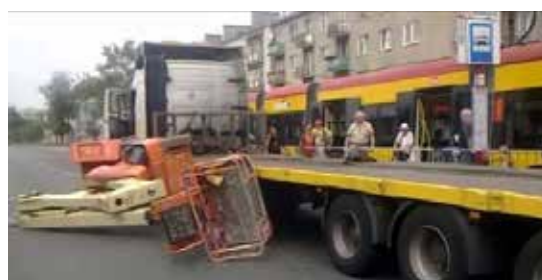
Figura 11. Caída de la PEMP durante la carga/descarga.
