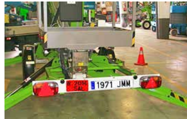
Figura 23. Sistema de señalización luminosa trasera.
