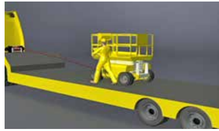
Figura 16. Uso del cabrestante para facilitar la carga o descarga.
