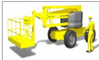
Figura 18. Comprobación del estado de la PEMP.
