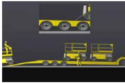
Figura 5. Sobrecarga de ejes durante la descarga de cargas mixtas.
