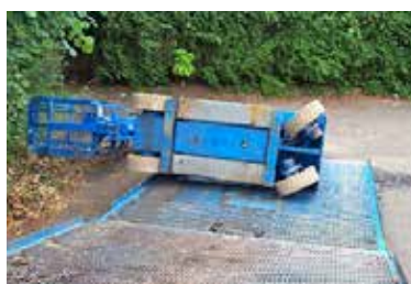
Figura 2. Vuelco de la PEMP durante la descarga.
