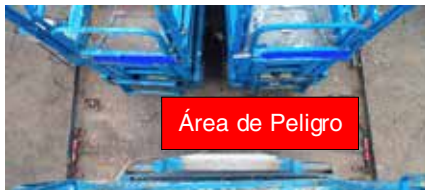
Figura 14. Zona de peligro de atrapamiento.
