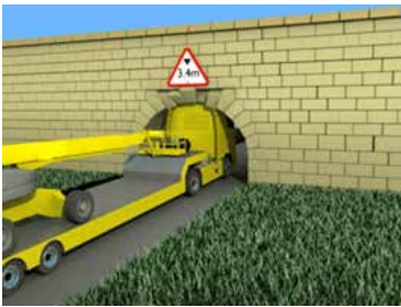
Figura 4. Choque contra un puente.
