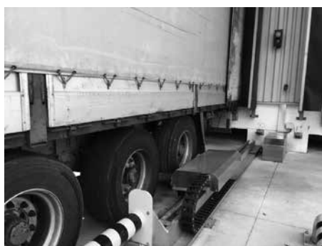
Figura 27. Sistema que automatiza todo el proceso de aproximación al muelle.
