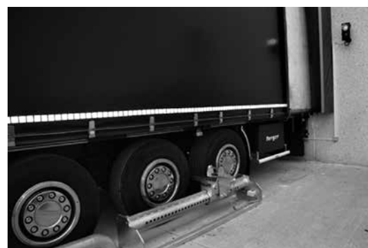
Figura 28. Modelo de sistema de bloqueo manual.
