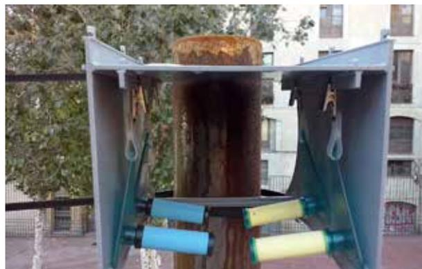
Figura 3. Estructura de protección (*shelter*) para la instalación de captadores pasivos
