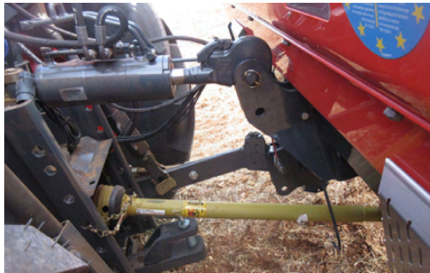
Figura 3. Enganche para acoplamiento al tractor y eje de transmisión de potencia.
