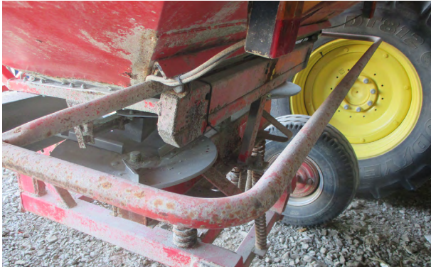
Figura 9. Protección de los componentes de distribución mediante barra distanciadora.
