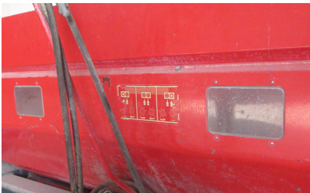
Figura 15. Ventana de inspección.
