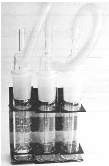
Fig. 2: Tren de impingers: borboteador fritado, borboteador normal y trampa
