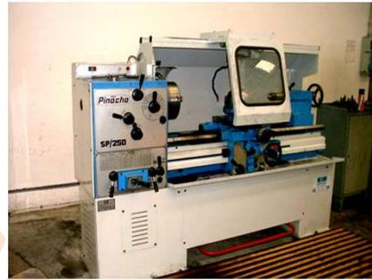
El resguardo móvil puede ser accionado manualmente o por una energía motriz distinta a la humana o la gravedad.
