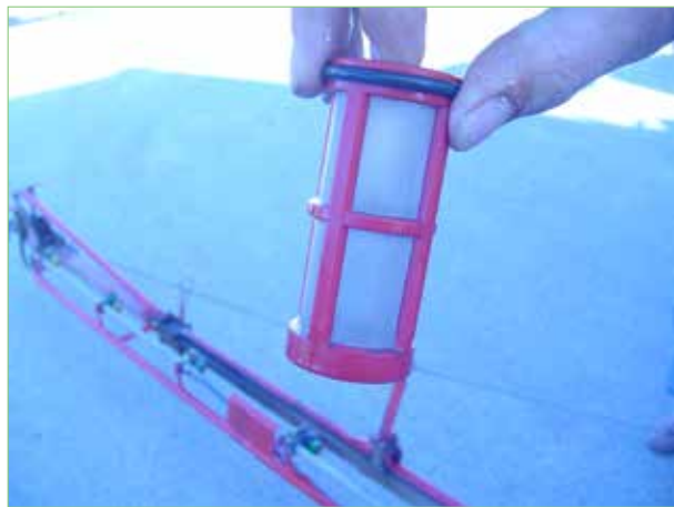
Figura 9. Cambio de filtro.
