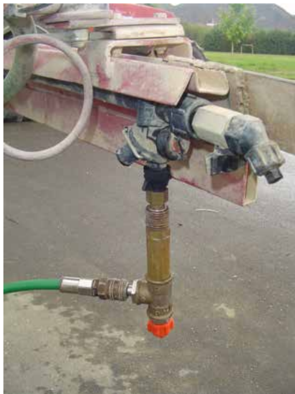
Figura 10. Acople para la medición de la caída de presión entre el manómetro y las boquillas.
