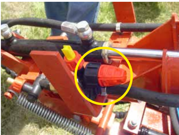
Figura 7. Boquilla con dispositivo antigoteo.
