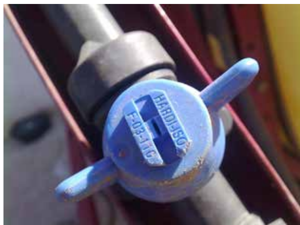
Figura 11. Boquilla marcada según código ISO.
