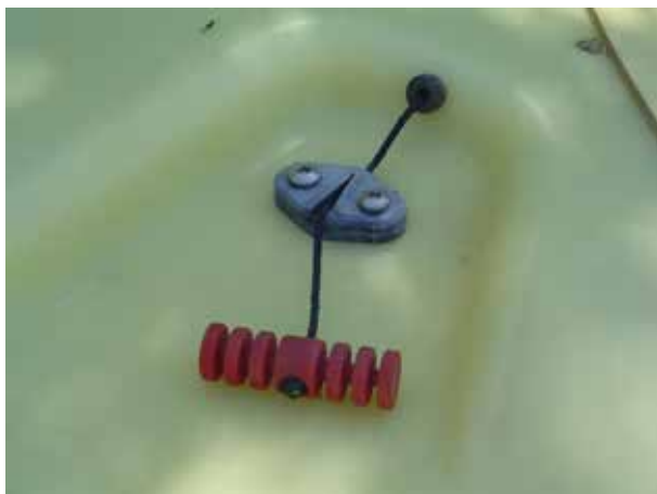
Figura 3. Dispositivo para facilitar el vaciado: tirador situado en el depósito que abre la salida.
