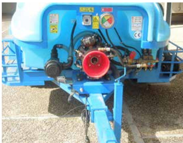
Figura 4. Dispositivos de regulación y control del pulverizador.
