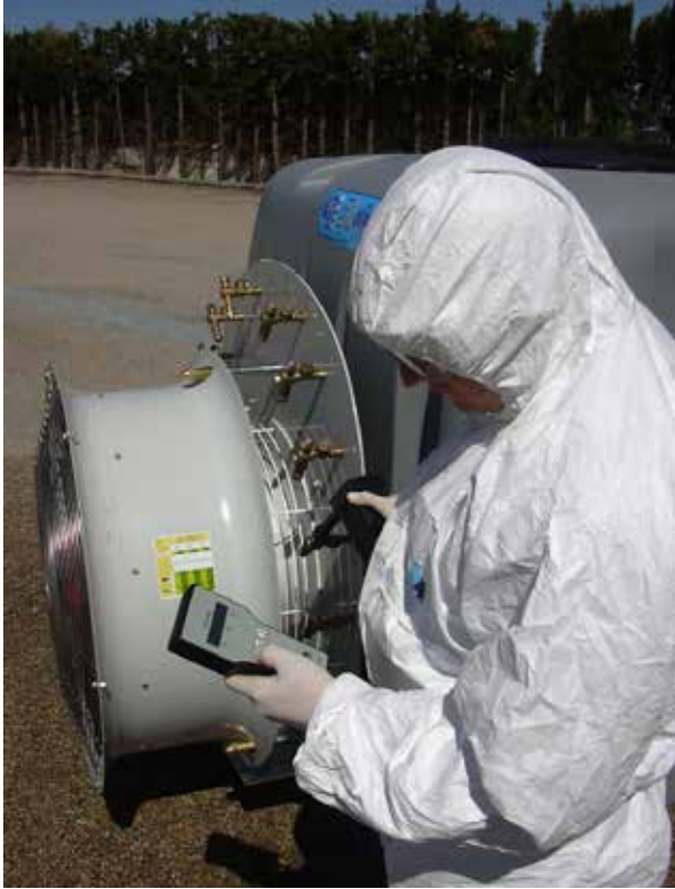
Figura 6. Ensayo de distribución vertical en un atomizador: medición del caudal de las boquillas.
