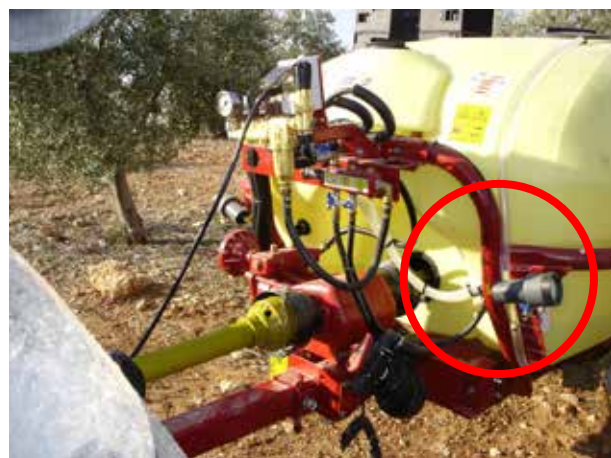
Figura 5b. Sensor de ultrasonidos: detecta la presencia de árboles para realizar la aplicación.
