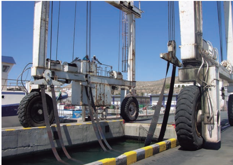
Colocación de las eslingas en la apertura a un nivel inferior al calado de la embarcación
