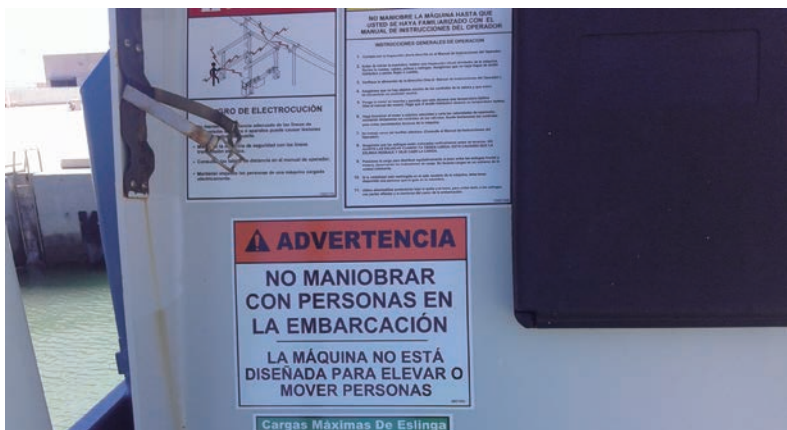
Señalización de advertencia para no maniobrar el travel-lift con personas subidas a la embarcación.
