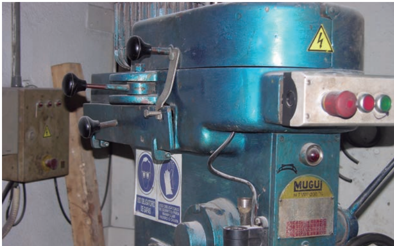
Mandos de accionamiento y señalización de un taladro
