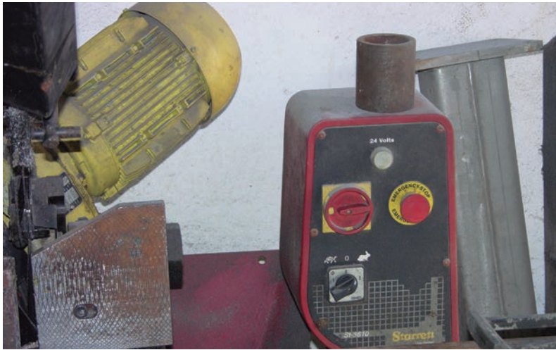
Parada de emergencia de una sierra de cinta
