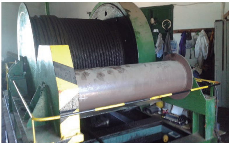
Cabrestante con barra distanciadora en el interior de una edificación
