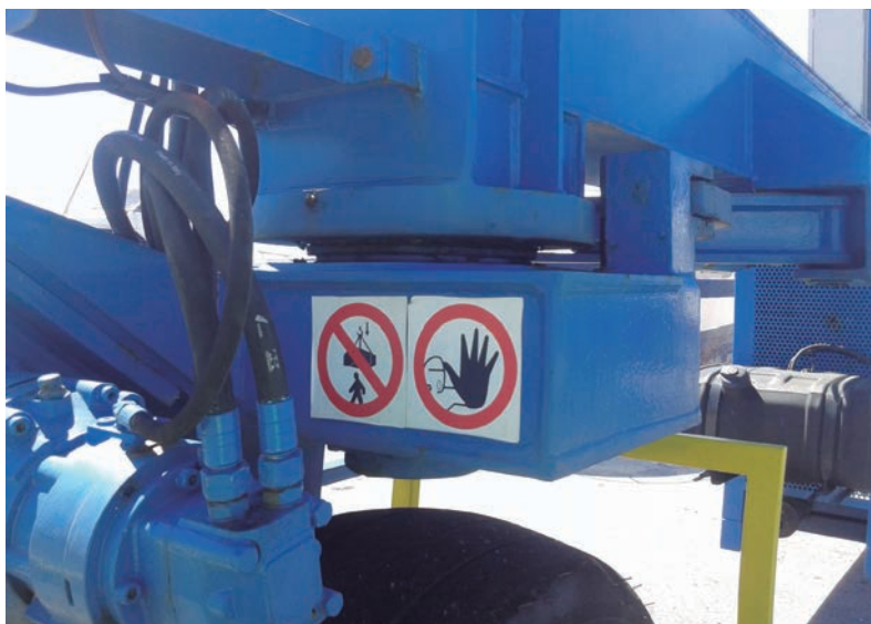
Señalización de prohibición de situarse bajo cargas suspendidas y de uso por personal no autorizado.
