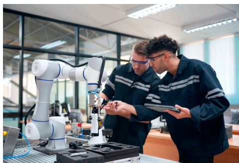
Figura 7. Preparación del robot colaborativo para una aplicación.
