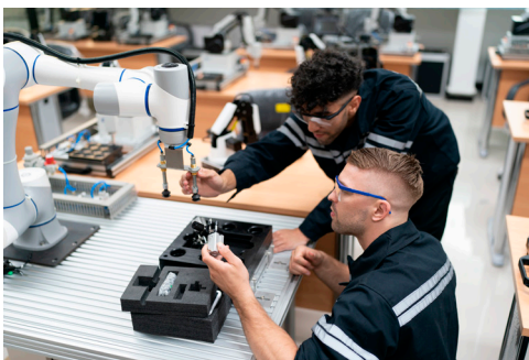
Figura 5. Cambio de elemento terminal de un robot colaborativo.
