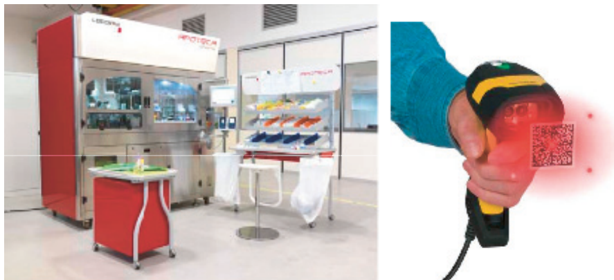
Fig. 8. Robot de preparación de fármacos citostáticos y lector de código de barras
