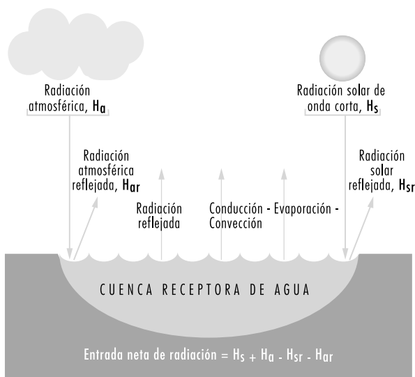
Figura 55.17 • Intercambio de calor en los límites de la sección transversal de una cuenca receptora de agua.
