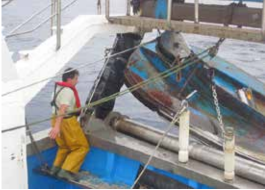
Figura 8. Virado de puertas deflectoras
