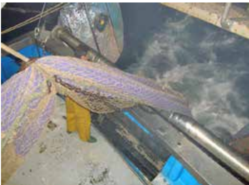
Figura 9. Virado del arte y maniobra del copo
