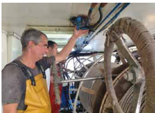
Figura 7. Operación de virado del cable
